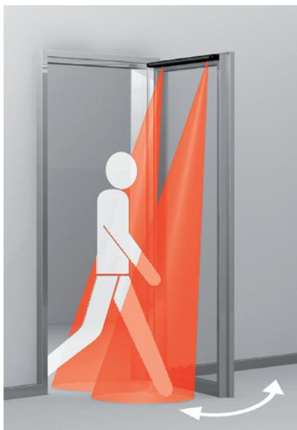
sensor de sécurité peut-être utilisé comme détection d'ouverture. Durant le cycle de fermeture, si le sensor de sécurité détecte une présence, le mouvement de la porte est inversé et celle-ci s'ouvre à nouveau.
