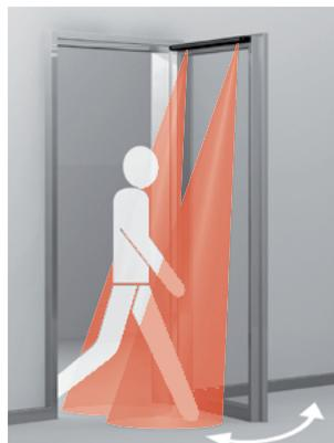
Le principe technique du bandeau de sécurité à bi-technologie active garantit la détection des personnes et d'objets. La zone de surveillance autorise une grande souplesse de réglage. Pour sécuriser la zone de pivotement de la porte, on utilise une lumière infrarouge. L'IRS -2 est un capteur infrarouge actif qui détecte tout ce qui se trouve dans son champ de détection, qu'il s'agisse de personnes ou d'objets, à l'arrêt
