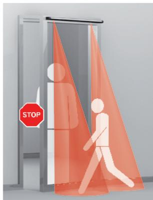
du capteur de ce côté de la porte, celle-ci se ouvre automatiquement sous l'effet d'une nouvelle impulsion de déclenchement transmise par le bandeau de sécurité à bi-technologie active. Côté paumelles, un déclenchement de capteur entraîne l'arrêt de la course d'ouverture automatique de la porte afin d'éviter toute collision avec des objets se trouvant dans l'angle de contact de l'IRS 2.
