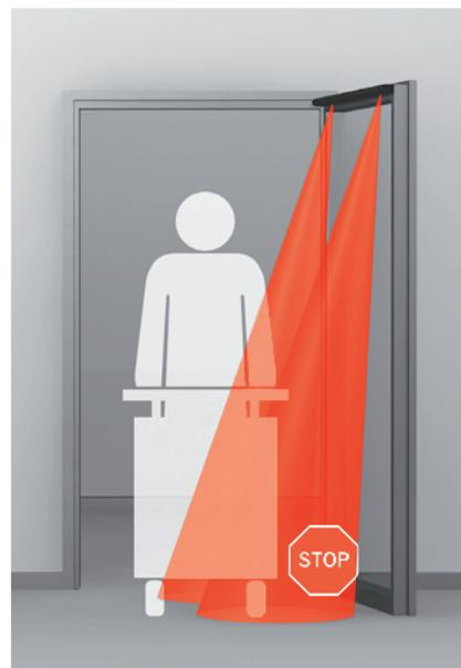
La temporisation de maintien à l'ouverture est relancée. Côté paumelles, durant le cycle d'ouverture, le mouvement de la porte est stoppé lorsque le sensor de sécurité détecte une présence. Dès que la temporisation de maintien à l'ouverture est
