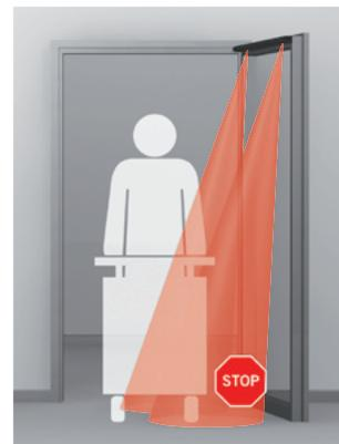
ou en mouvement. L'IRS-2 est disponible en différentes longueurs et avec un nombre variable de capteurs infrarouges. DORMA préconise de choisir le modèle IRS-2 le plus long possible avec un maximum de capteurs infrarouges intégrés en fonction de la largeur de la porte afin d'augmenter le champ de détection du système et assurer ainsi une sécurité maximale de la porte battante.
